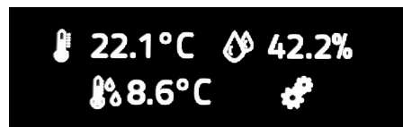
Rysunek 10. Wyniki pomiaru temperatury i wilgotności, punktu rosy, status przetwornika PM: trwa pomiar
